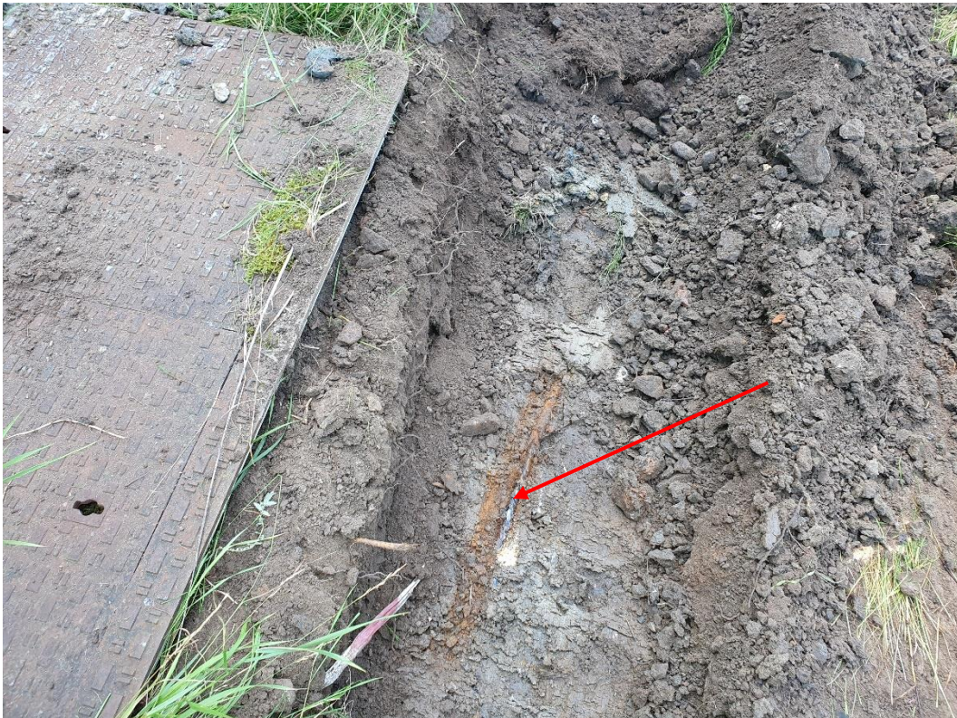
Figur 5: Provpunkt 21AF04. Lättdolkabel noterades på ca 0,3 m.u.my. Bildkälla: AFRY 2021-07-19.
